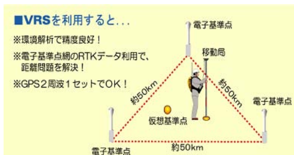
図-2 VRSリアルタイム測量のメリット
