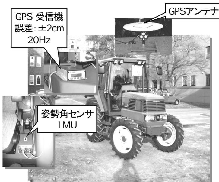
写真1 ロボットトラクタと航法センサ
