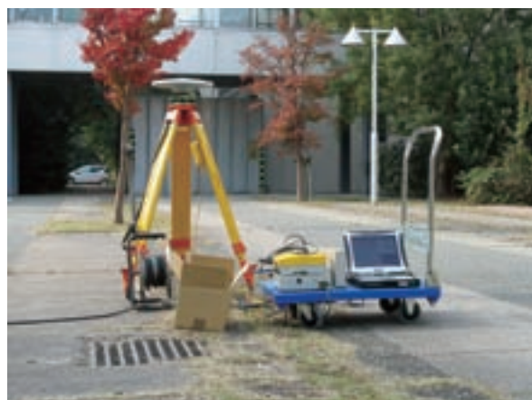
図3 地理院構内での観測風景。観測点では、通常のGNSSアンテナでGPSの測位信号及び準天頂衛星のLEX信号を受信し、分配機を用いてGPS受信機（一周波型）及びLEX信号受信機にそれぞれ分配後、各受信機の出力をPCで処理して測位解を求める。
