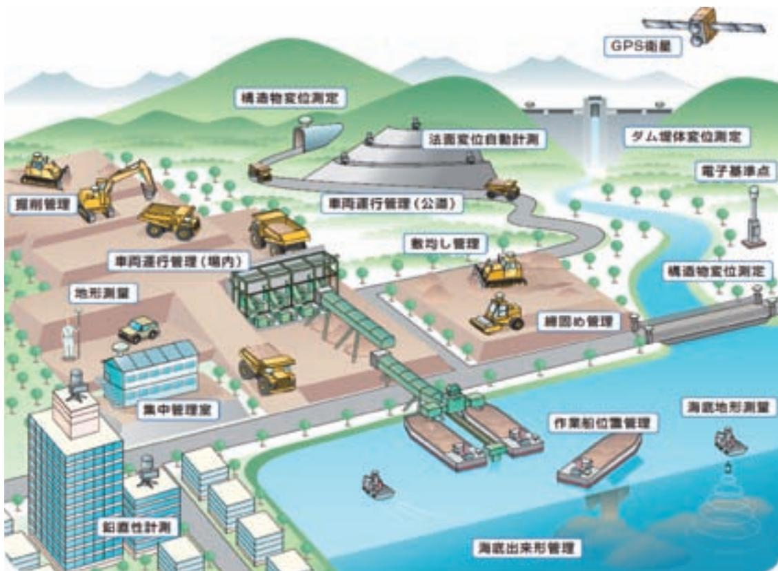
図1 GNSSの情報化施工における活用イメージ
