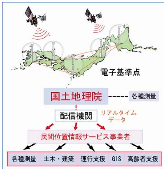
図9. 電子基準点リアルタイムデータ提供
