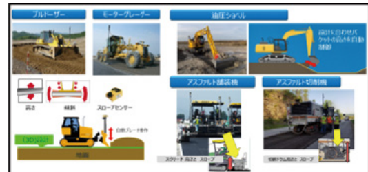
図2 MC・MG が使用される重機
