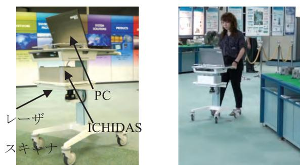
図3 計測台車（左）と計測の様子（右）
