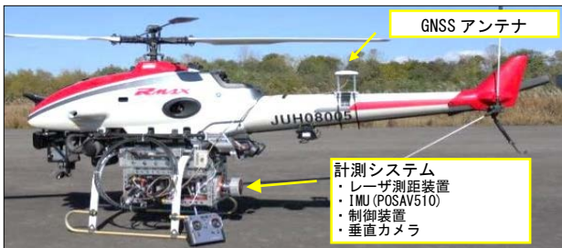
図 1 産業用 UAV（ヤマハ社製 R-MAX）によるシステム
